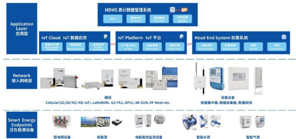
图17: 公司设计提供的国际能源物联网 AMI 系统
