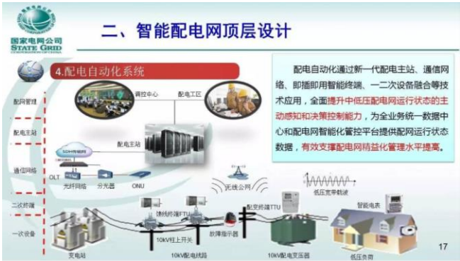
图12：国家电网公司披露的智能配电网顶层设计
