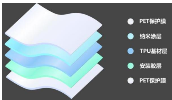
图表 20 隐形车衣结构图
