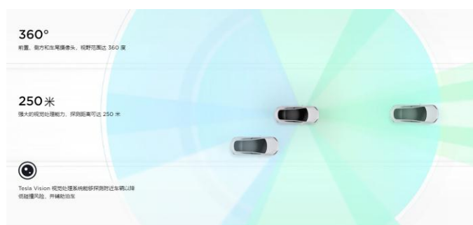
图表10：特斯拉 Model3 智能驾驶以摄像头为主
