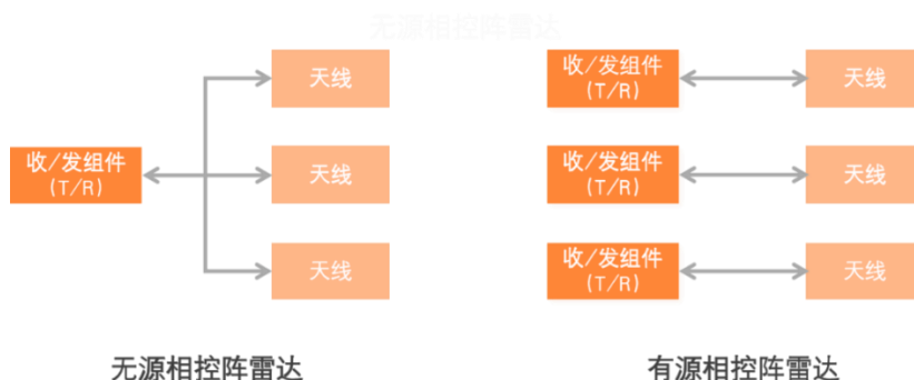
图表41 有源相控阵雷达每个天线单元对应一个收/发组件
