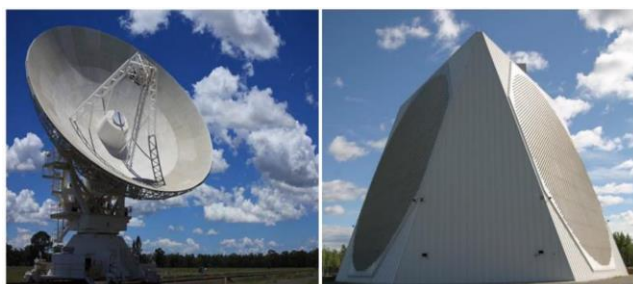
图表39 机械扫描雷达（左）和相控阵雷达（右）
