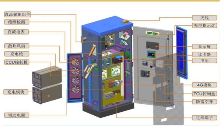
图表 14: 直流充电桩结构
