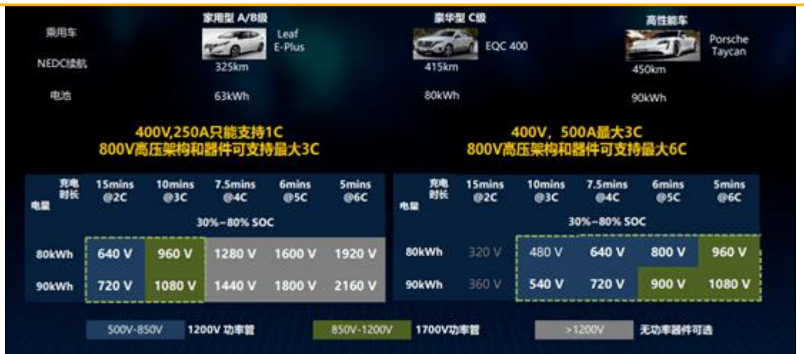
图表 40：800V 高压架构可支持最大 6C 快充
