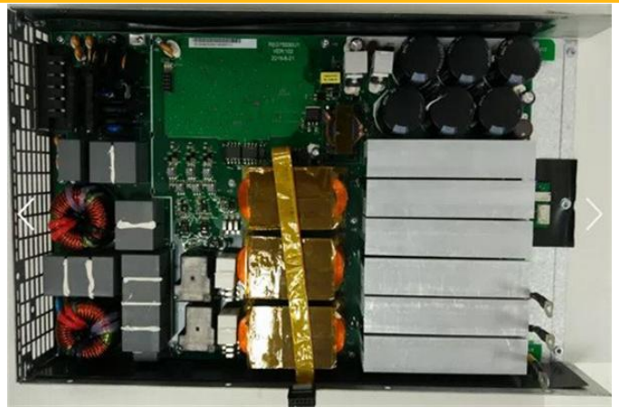
图表 20：直流充电模块内部构造
