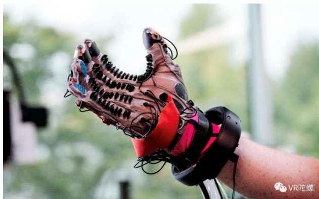
图 42: 触觉手套上遍布上百个执行器捕捉信息和传递触觉
