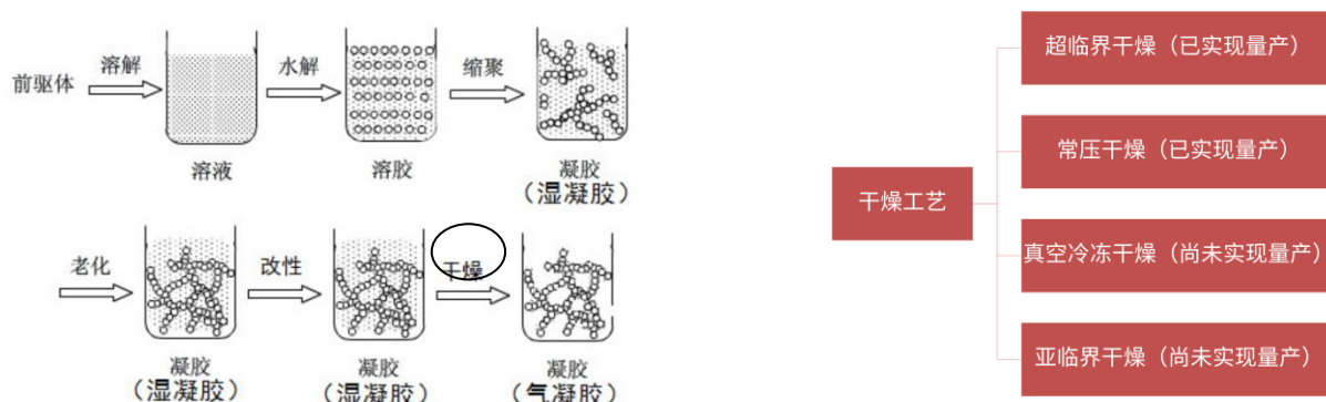
图 5：气凝胶制作工艺路线
