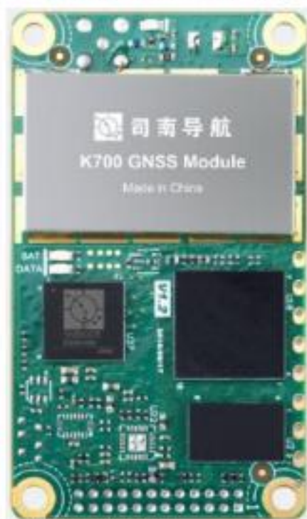
图17：司南K700GNSS板卡可广泛应用于测绘等领域
