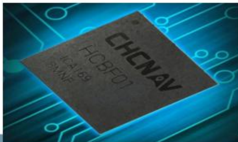
图27: 璇玑芯片支持北斗三代等五星十六频，实现厘米级定位
