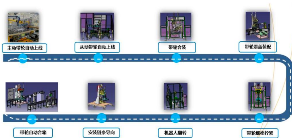
图 41：公司变速箱装配线能够针对各类变速箱完成柔性制造
