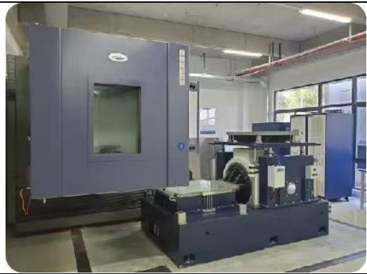
图 69: 思源实验室温度、湿度、振动三综合试验台
