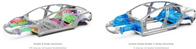
图5：一体化压铸将上百个零部件减少到几个，降本增效
