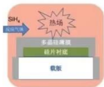
图 12：LPCVD 工艺原理示意图
