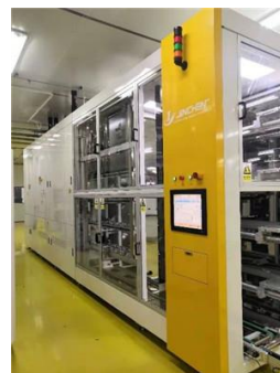
图 15：金辰股份 TOPCon 用管式 PECVD 设备示意图
