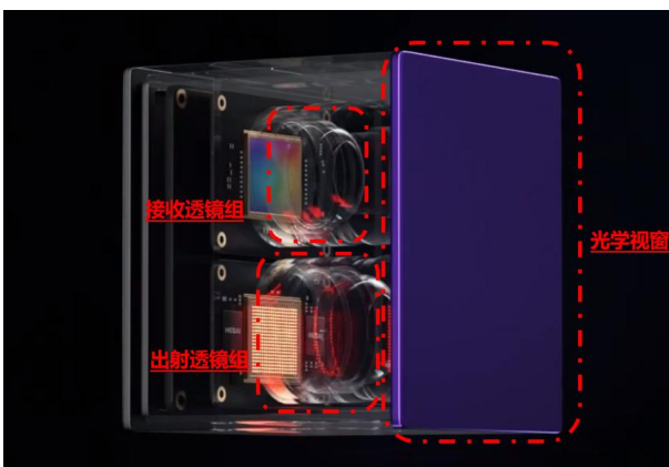
图 29: 禾赛科技补盲雷达中的光学元件
