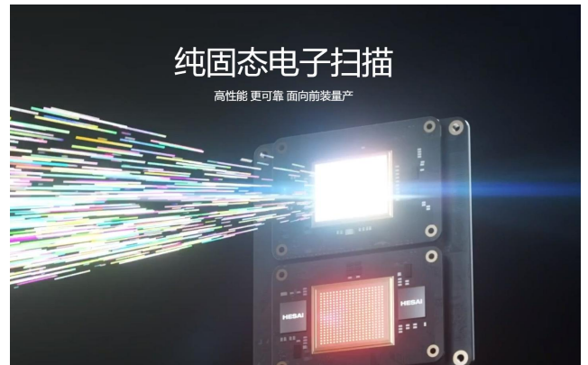
图 28: 禾赛科技的补盲雷达采用纯固态方案
