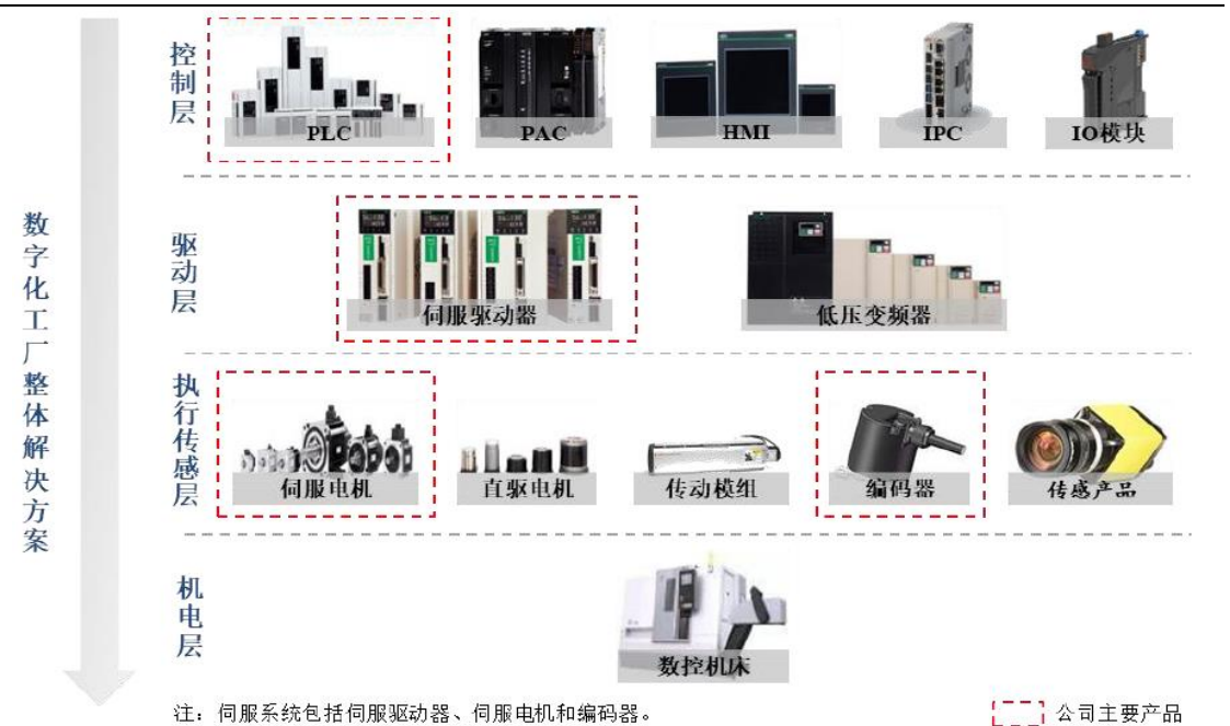
图 3：公司实现了对工控设备各层级主要产品的覆盖
