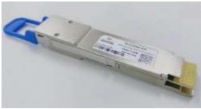
图 31: 量产版 400G QSFP-DD DR4 硅光模块
