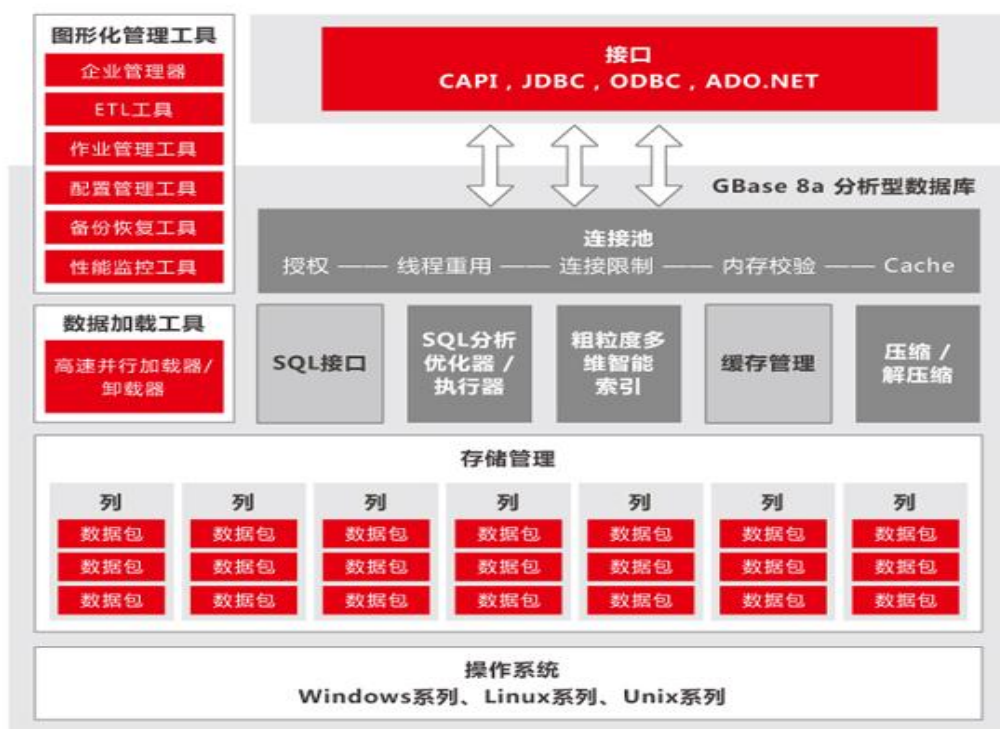
图27：GBase 8a 分析型数据库产品架构
