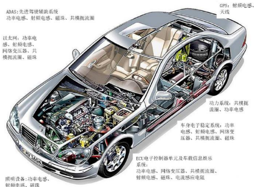
图13：新能源汽车所需磁性器件的模块多，包含动力系统、辅助驾驶系统等
