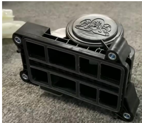
图31： 特斯拉 model Y 八通阀实现电池、电机电控、Chiller 冷却、水冷冷凝器制热的最优配置
