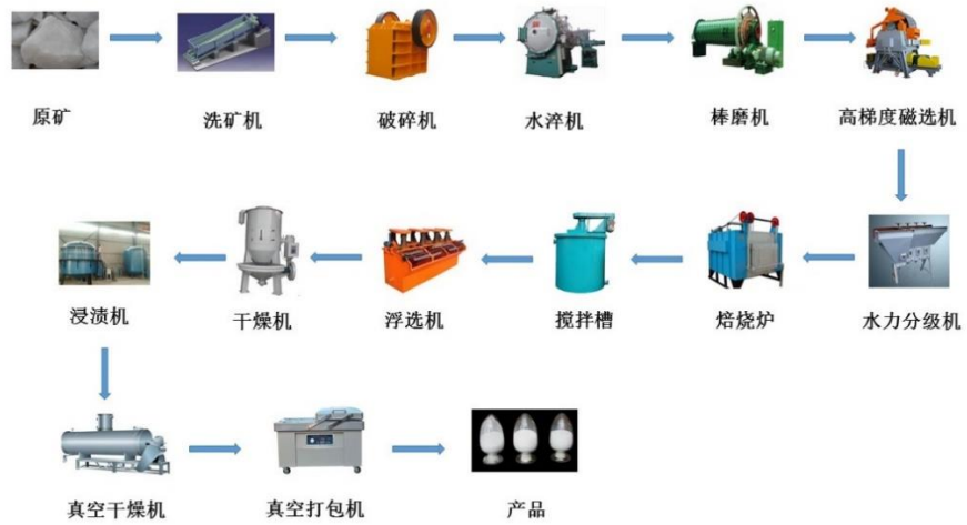
图 54：高纯石英砂提纯工艺流程示意图
