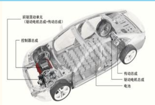
图表 44：电驱系统在新能源上的安装位置
