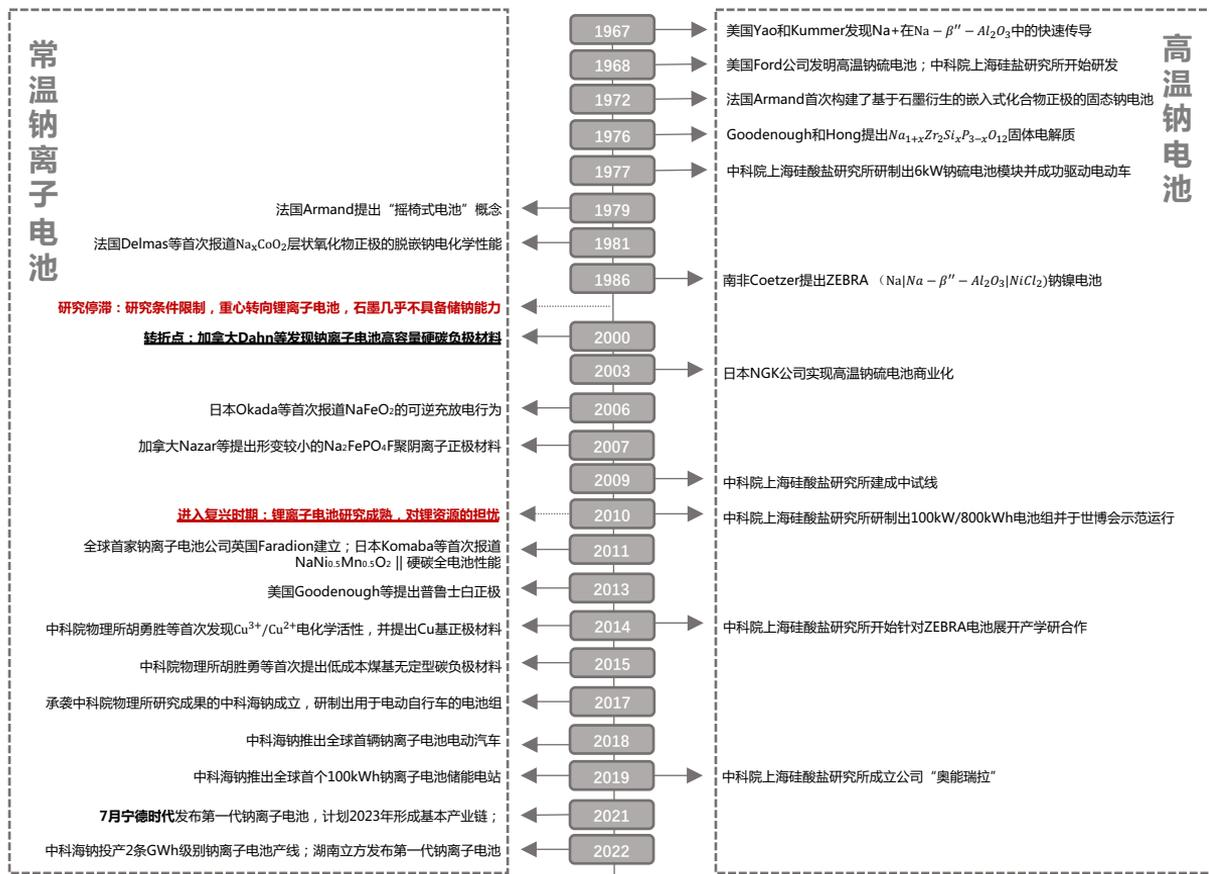
资料来源：中科院物理所，华福证券研究所；注：高温钠电池主要包括钠硫电池和ZEBRA电池，用可实现钠离子导电的陶瓷电解质作为离子交换的隔膜，并将金属钠或者化合物形式的钠作为电价变化的活性物质制造二次发电电池，必须在高温下才能运行。而常温钠离子电池类似于锂离子电池，依靠钠离子在正负极之间的嵌入脱出和迁移实现充放电过程。
