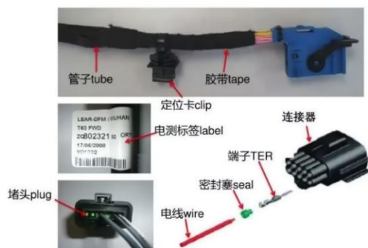
图37：汽车线束组成
