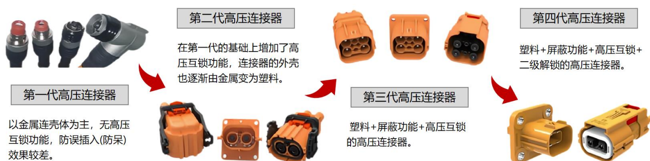
图44：汽车高压连接器迭代
