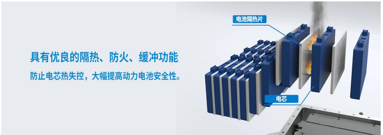
图1：气凝胶隔热示意图
