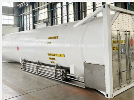
液氢储运装置
