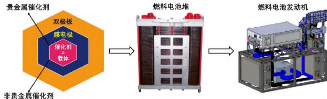
图：燃料电池结构及实物
