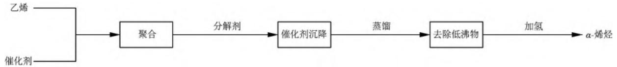
图 1 乙烯齐聚工艺流程
