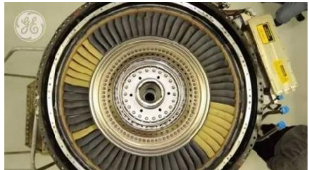
图34 斯奈克玛将陶瓷基复合材料应用于燃烧室火焰筒和火焰稳定器 图35 GE 公司采用陶瓷基复合材料叶片的涡轮转子
