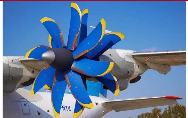
图 14: 安-70 运输机使用的 D-27 桨扇发动机
