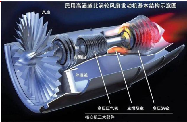
图 6：涡轮风扇发动机结构
