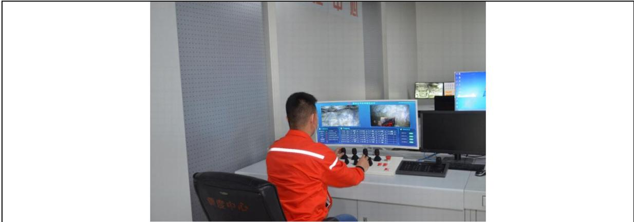
图 3-40 5G 无人化掘进操控台
