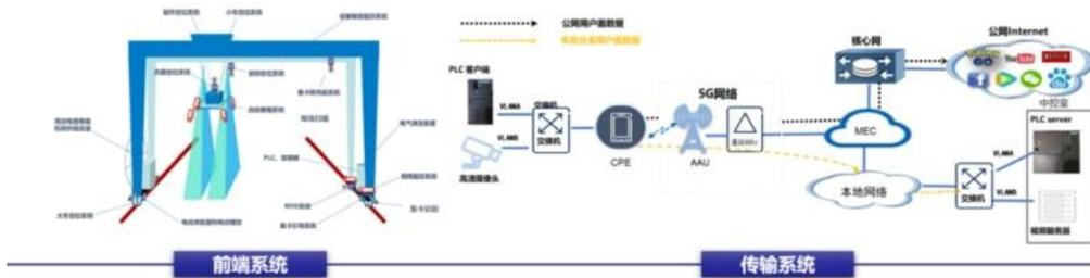
图 3-23 5G 港机远控架构图
