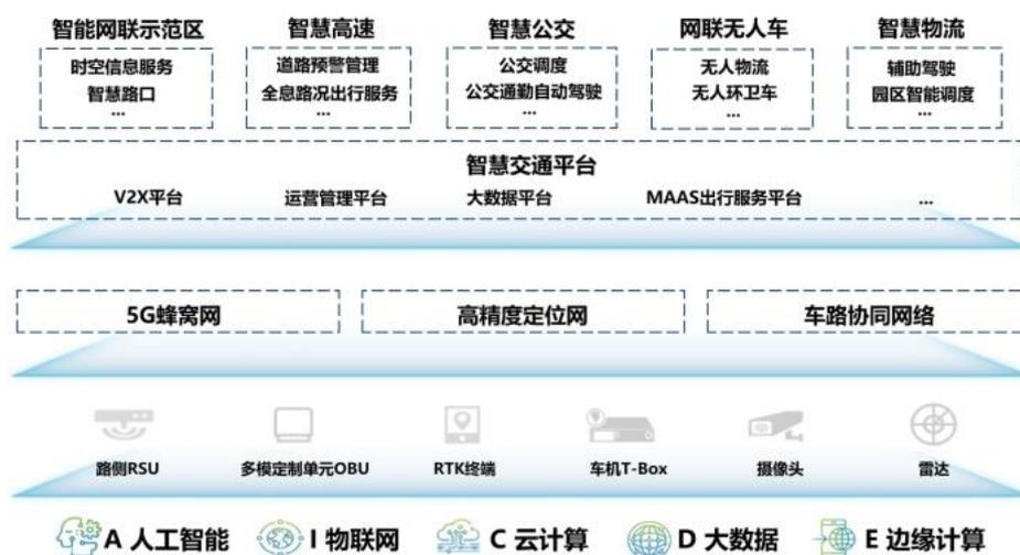
图 3-15 5G+车联网总体架构
