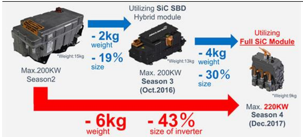
图26: Rohm 的 SiC 功率模块使得逆变器的尺寸和重量大大减少
