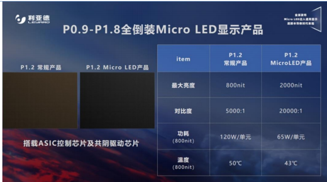
图 30：利亚德 Micro LED 显示产品与常规产品对比
