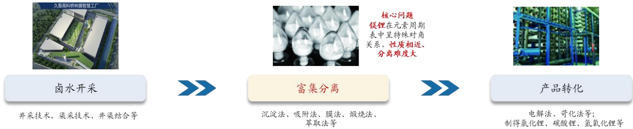
图 34：盐湖提锂工艺流程：分离镁锂为问题关键
