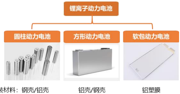
图表2 常见动力电池封装工艺及材料
