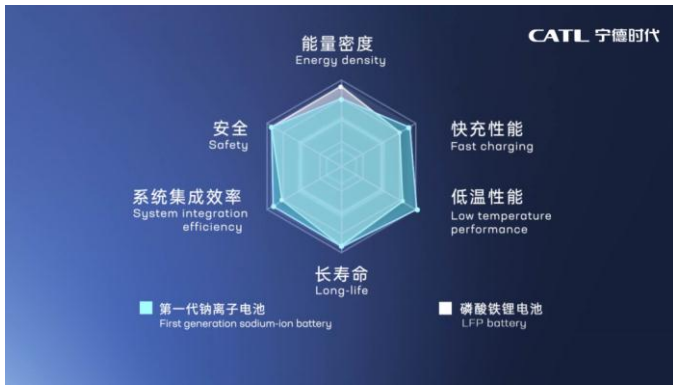
图 30：宁德时代钠离子电池与磷酸铁锂电池对比
