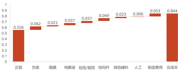
图 6：NCM811 锂电池电芯成本结构
