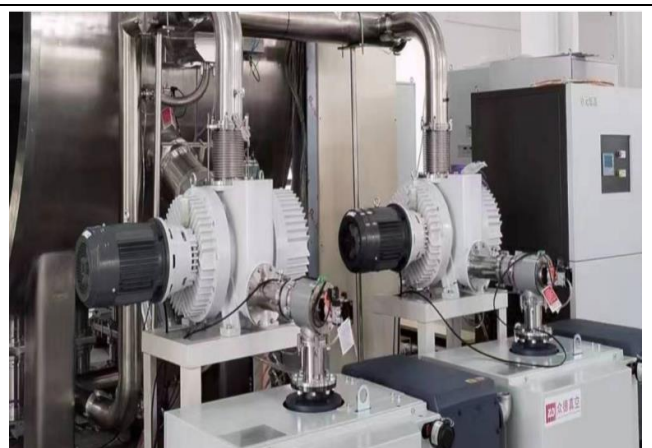
图表 56: 东威科技锂电复合铜膜磁控溅射卷绕双面镀膜设备
