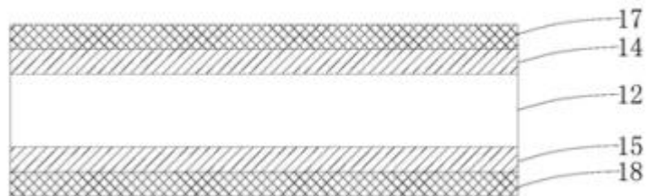
图表 23：基膜 (12) +金属化层 (14、15) +铜层 (17、18) 的复合铜箔
