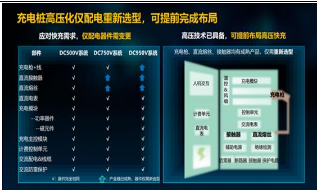
图表 75：充电桩高压化配件升级
