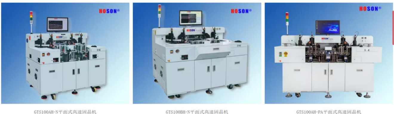
图表 58: 新益昌 LED 类固晶机
