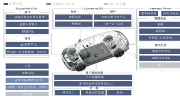
图18: 零跑汽车自研自制的核心系统及电子部件
