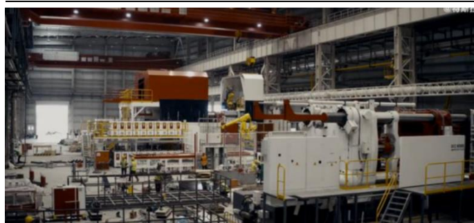
图30：采用大型压铸机一体成型能减少场地占用成本
