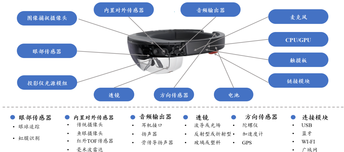
图41：AR设备零部件结构
