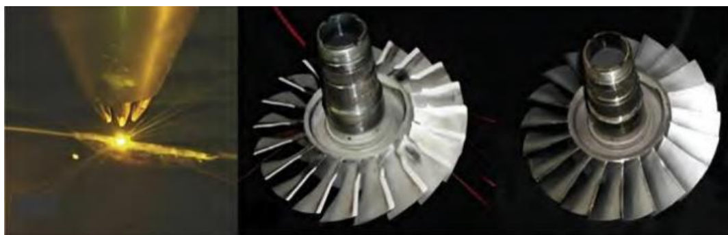
图 47: 增材修复在航空发动机整体叶盘上的应用
