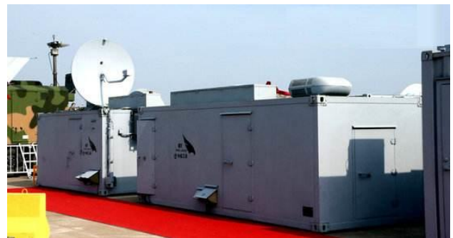
图 19：翼龙无人机系统的地面控制站
