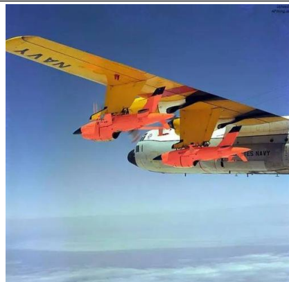
图 4：DC-130 运输机携带的“火蜂”无人机
