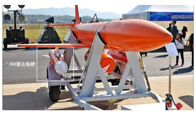
图 77：MQM-107D 携带的 TRX 型雷达拖靶
