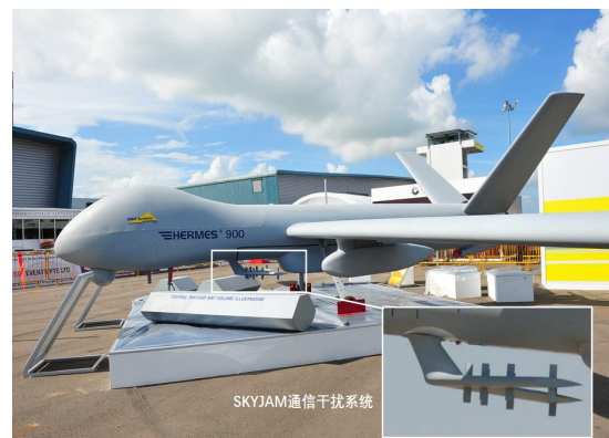
图 31：Hermes 900 的通信干扰系统（SKYJAM）
