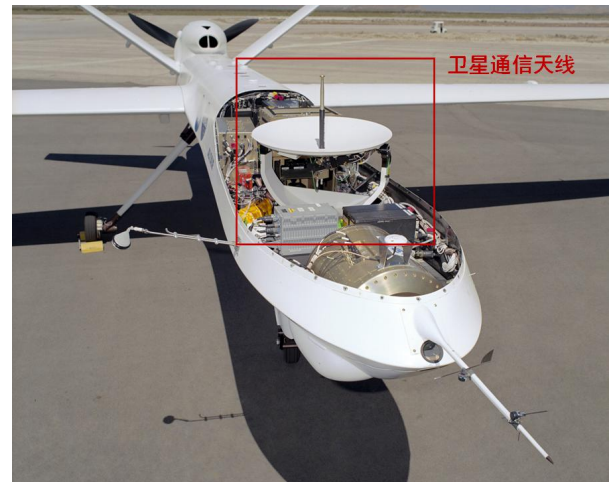
图 39: MQ-9 “死神” 的卫星通信天线
