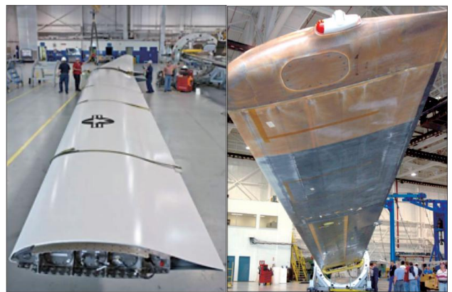
图 67：“全球鹰”复合材料机翼（左）及翼尖结构
