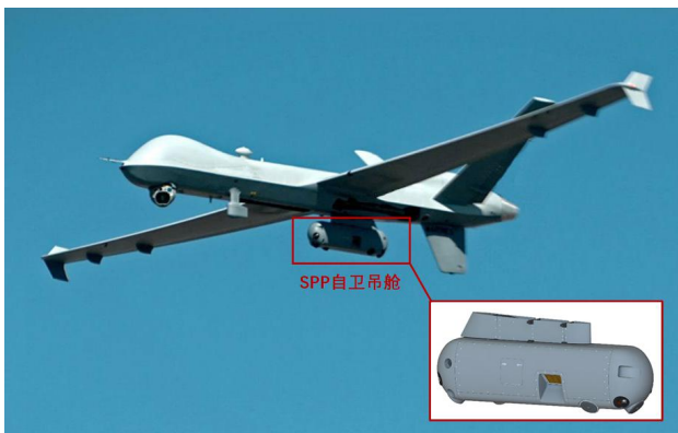
图 30：MQ-9 配置的自卫吊舱（SPP）
