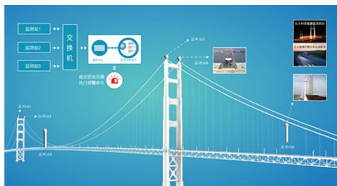
图 24：华测导航南京四桥北斗变形监测系统
