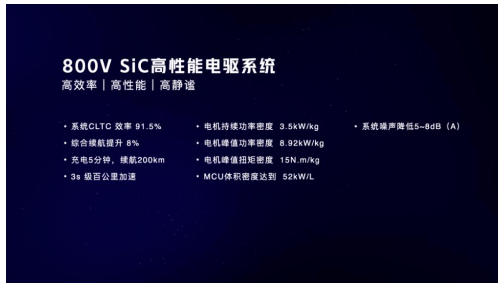
图 1：哪吒汽车 800V 高性能电驱系统参数
