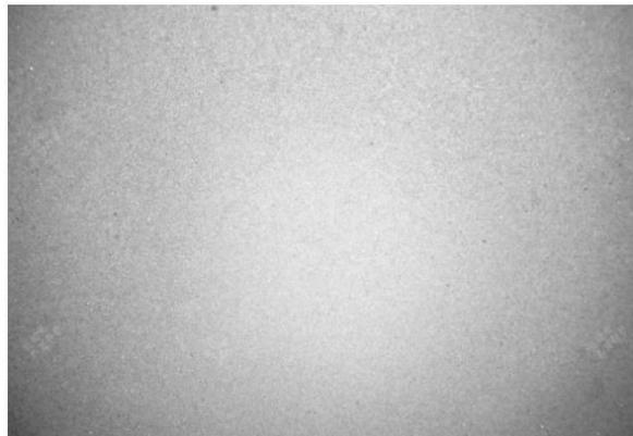
• 正极浆料涂布极片后的CCD图，无明显团聚
