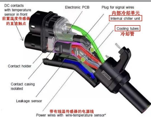
图33：液冷直流充电枪图示
