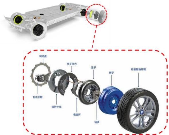
图44: 轮毂电机结构
