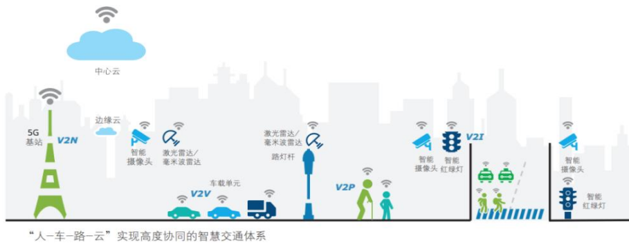
图 9: 车联网结构概览: 人车路云互相连接协作, 实现交通出行的智能化
