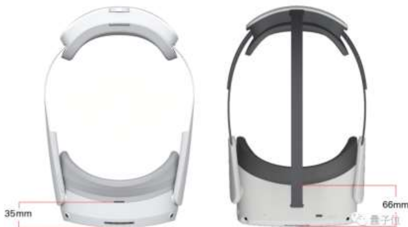
图 71: PICO 4（采用 Pancake 光学方案）vs PICO Neo3（采用菲涅尔透镜方案）
