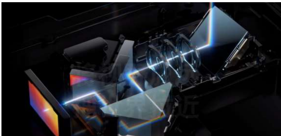
图 74：华为 P40 Pro+通过多次发射延长光路
