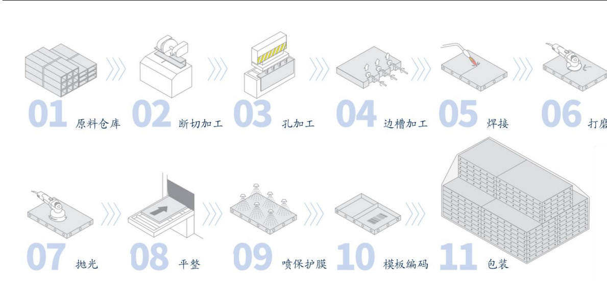
图：铝模板生产流程示意图
